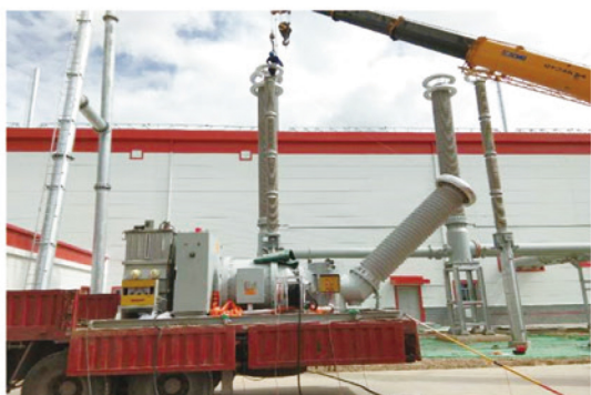
藏中联网芒康站 500kV CVT 误差校准试验
