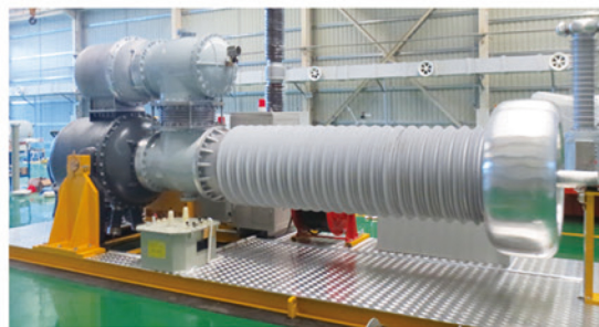
特高压耐压平台
