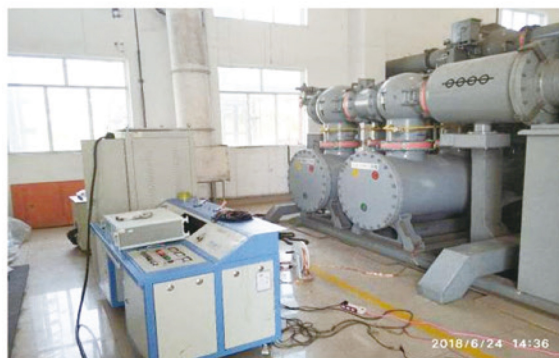
华能日照电厂 220kVGIS CT 校准试验
