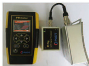
特高频超声波在线监测局放仪
