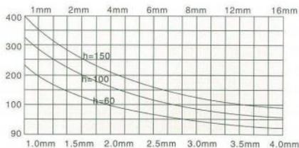
注: 托盘式电缆桥架在不同跨距下最大允许均布载荷及变形量图表
