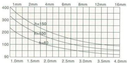
注: 梯级式电缆桥架在不同跨距下最大允许均布载荷及变形量图表
