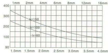
注: 槽式电缆桥架在不同跨距下最大允许均布载荷及变形量图表
