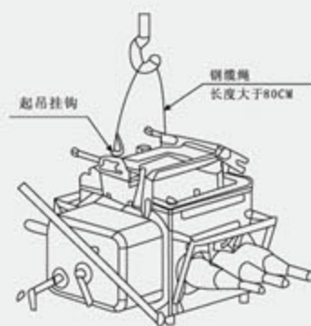
①FZW28-12系列户外分界真空负荷开关控制装置安装示意图
