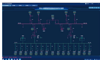
变电站综合自动化
